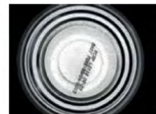
Keine Blendungen, der Aufdruck auf einer metallischen Oberfläche ist sichtbar.
