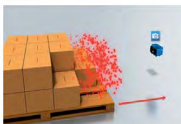
Zweiter Schritt: Messung der Zeit, die das Licht benötigt, um zur Kamera zurückzukehren.
